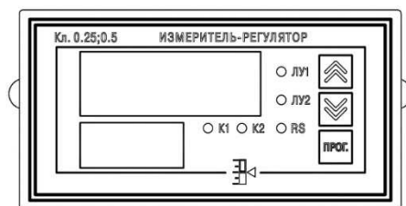
Рисунок 17. Измеритель-регулятор воздухонагревателей мощностью свыше 540кВт
